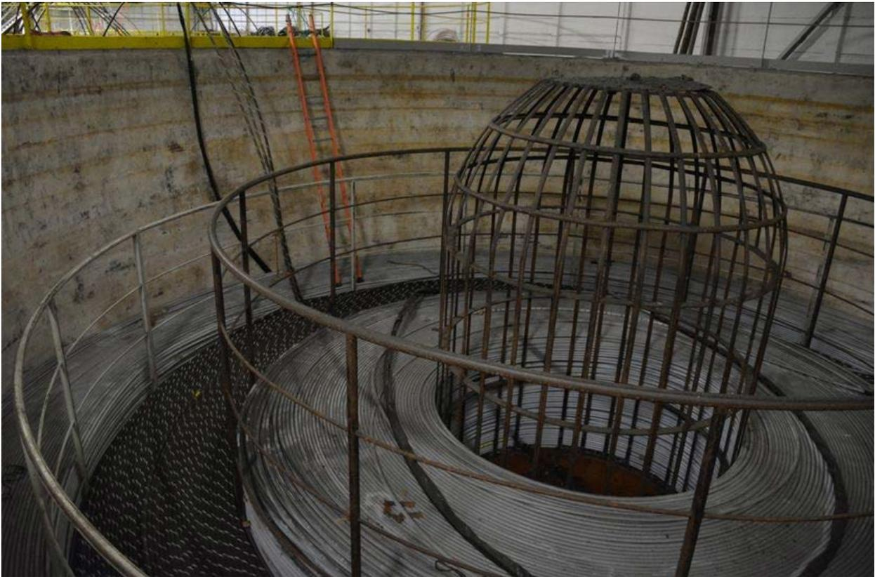
À terre (Brest), Orange Marine a installé son dépôt de câbles. Chacun est construit sur mesure et il faut conserver l'exact modèle d'origine pour réparer ceux déjà déployés dans l'Atlantique. •
