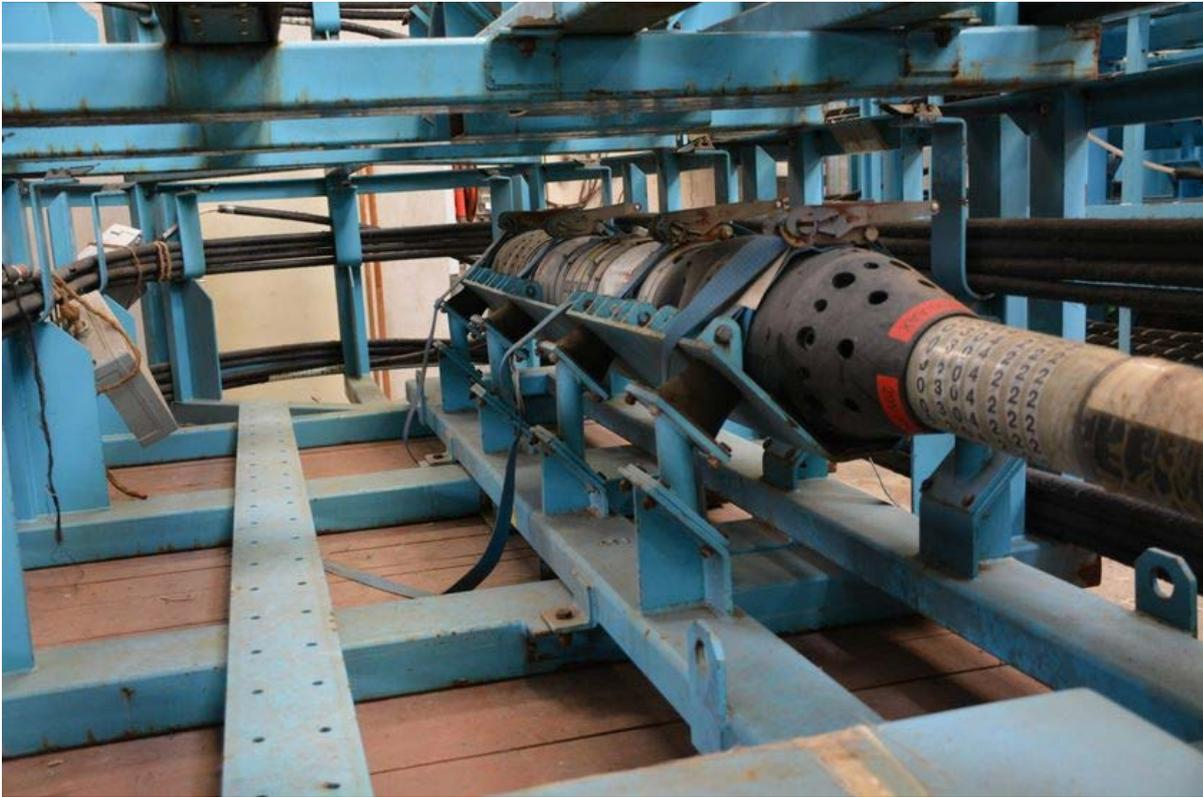
Pour que le signal lumineux ne s'atténue pas, des répéteurs amplifient le signal tous les 80 ou 100 km. Un répéteur coûte plus de 100 000 euros pièce. •
