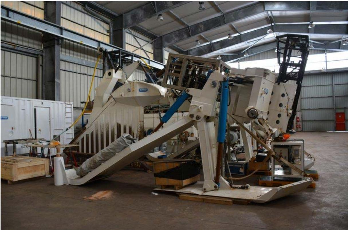
Pour protéger le câble des ancrages ou des chaluts, il est parfois ensouillé, enterré sous le fond marin, à l'aide d'une charrue telle que celle-ci : elle s'appelle Emma et pèse plus de 20 tonnes.
